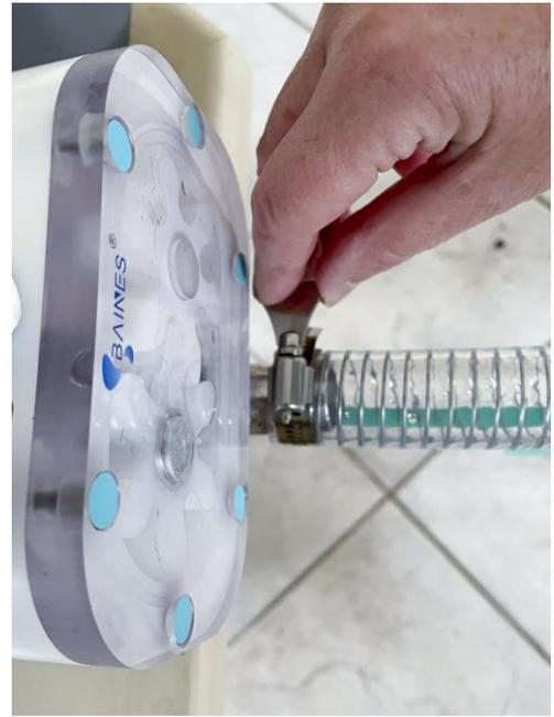
An der Zahnradpumpe muss nun noch der Ansaugschlauch, der in den Honigkessel getaucht wird, montiert werden. Den Schlauch gut nach hinten bewegen und die Schlauch Bride anziehen.
