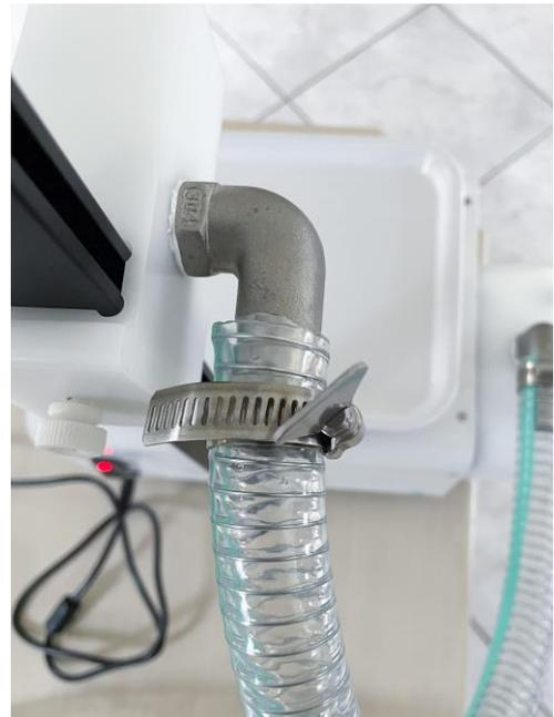
Der Schlauch kann unten an der Zahnradpumpe bereits mit der Schlauch Bride befestigt werden. Oben am Ausflussteil lassen wir die Bride noch offen. Hier wird dann der erste Honig in die Zahnradpumpe gefüllt.
